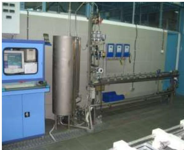
Sam postupak inspekcije vodomjera najvećim dijelom se provodi automatski, gdje instalirani softverski paket vrši propisana mjerena, proračun odstupanja pokazivanja vodomjera u odnosu na referentni etalon u područjima provjere vodomjera i davanje ocjene o prihvatljivosti dobivenih rezultata u odnosu na dozvoljena odstupanja, čime je uticaj ljudskog faktora na pouzdanost dobijenih rezultata sveden na najmanji propisani nivo.
